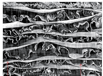
弹性层 褶皱/非弹性层 (经由拉伸与部分脱层) TPE/PP+CaCO 3
